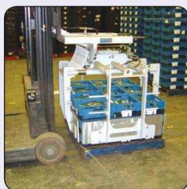
本製品は、フォークリフトのフォークに簡易脱着可能なモデルであり、フォークリフトをレイヤーピッカー専用ではなく、多種作業で使用する場合に適しています。弊社製の簡易脱着式の油圧カプラと取付フックを使用することにより、数分で脱着作業が完了します。弊社製サイドシフターと併用することにより、さらに多用途での使用が可能となります。ガイドレールシステムは不要ですが、スイング機能へは対応していません。
