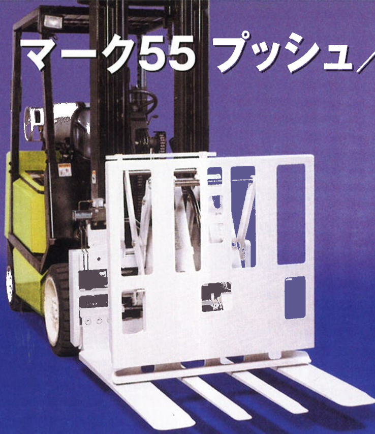
2. プラテン開 スリップシート (シートパレット) 作業時
